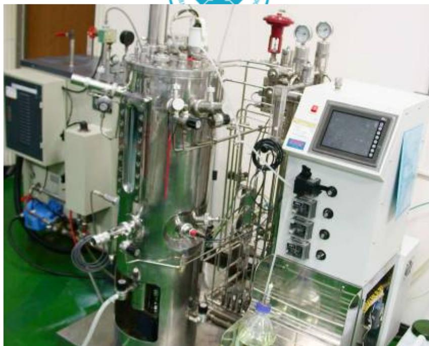
圖 2-2 三十公升攪拌式發酵槽外觀圖
